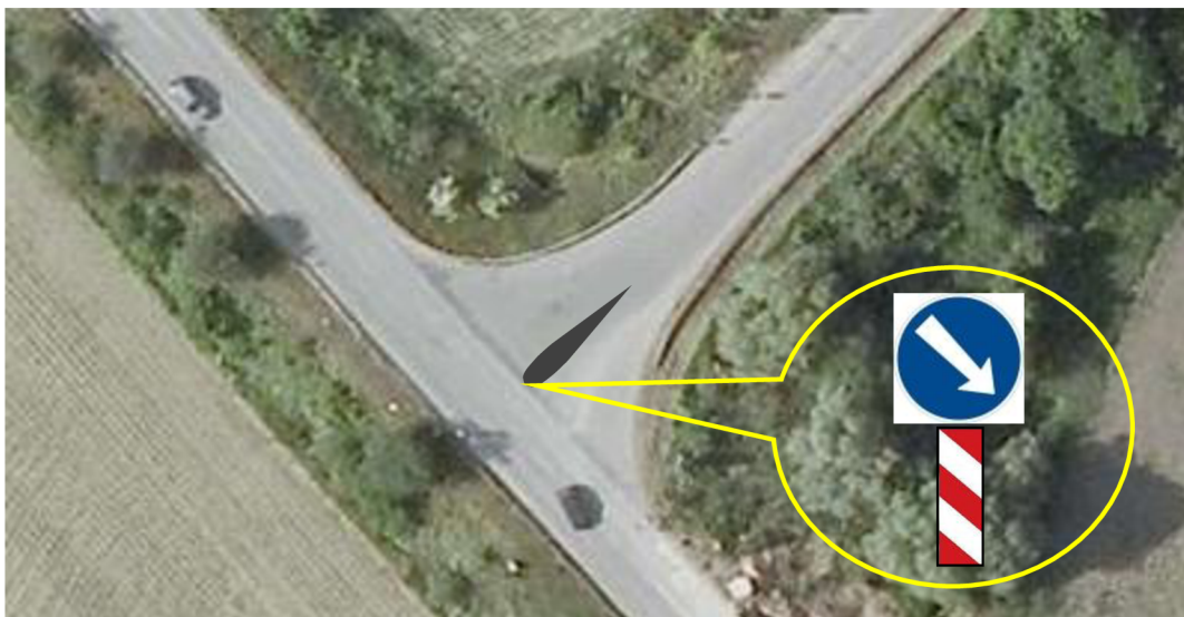
Obrázek 8: Fotomontáž navrhované úpravy dopravního ostrůvku [39]
