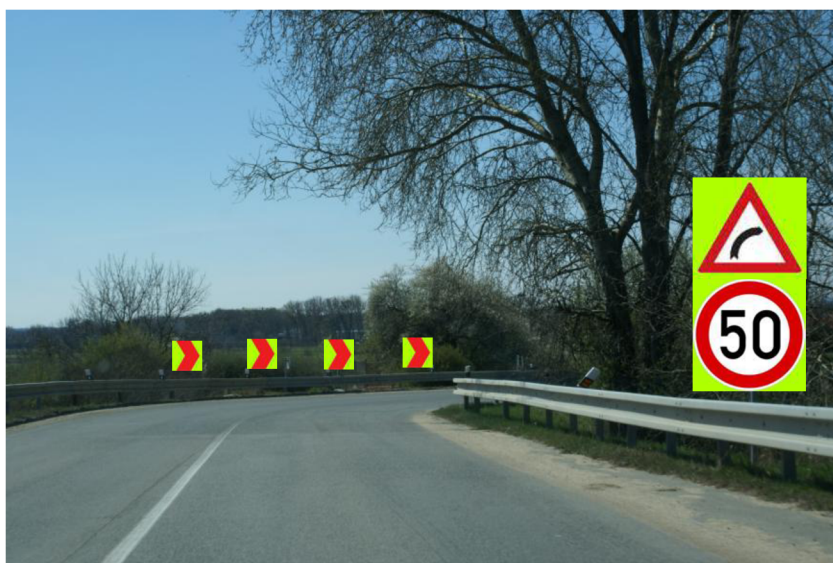
Obrázek 27: Fotomontáž navrhované úpravy retroreflexního dopravního značení [39]
