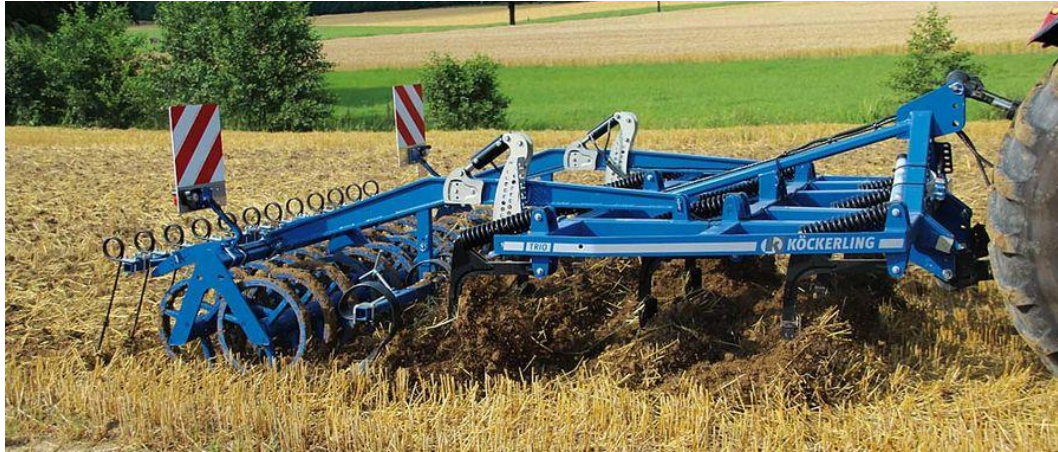
Obr. č. 5 Radličkový kypřič Köckerling TRIO (KÖCKERLING, 2019)
