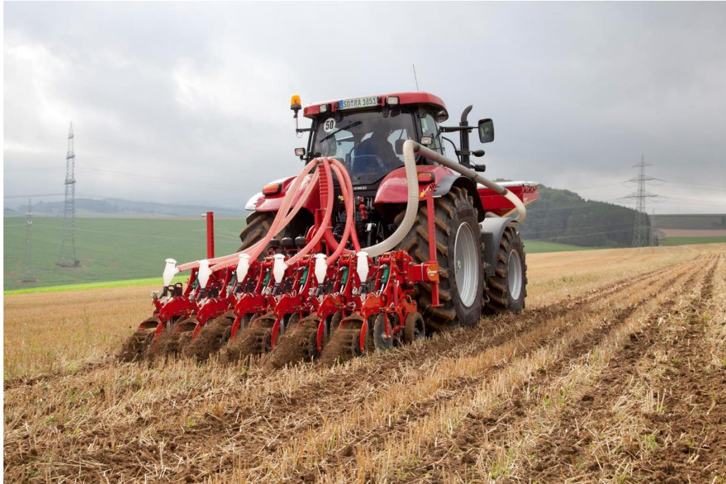
Obr. č. 3 Secí stroj pro přímé setí do nepracované půdy Kverneland Kultistip (KVERNELAND, 2019)
