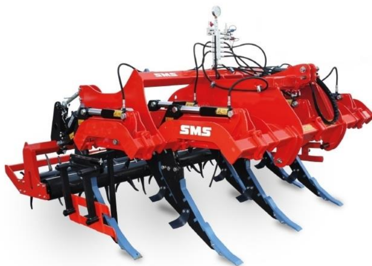
Obr. č. 7 Dlátový kypřič TALON MAX (SMS CZ, 2017)
