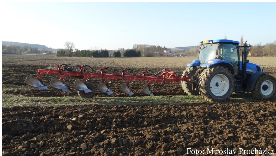
Obr. č. 13 Fortschritt B201 v agregaci s New Holland T6050
