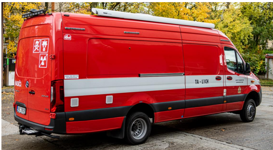
obr. č. 4 Technický automobil chemický v lehkém provedení
