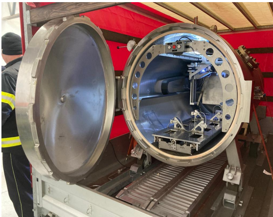
obr. č. 14 Přetlaková plynotěsná komora
