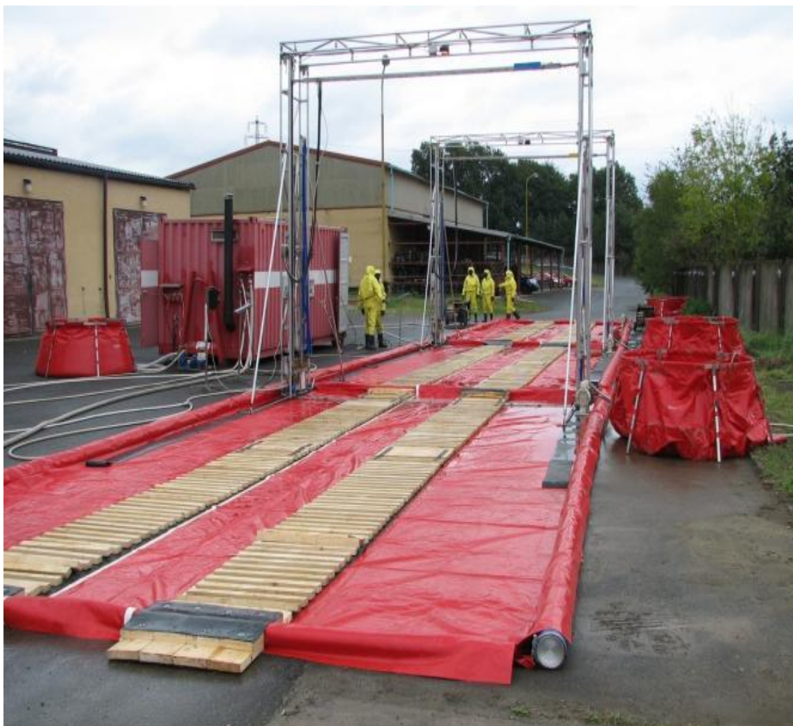
obr. č. 10 Rozložený kontejner dekontaminace techniky
