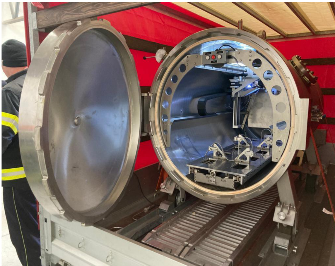
obr. č. 14 Přetlaková plynotěsná komora
