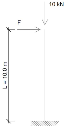
Obr. 8.1: Geometrie sloupu se zatížením
