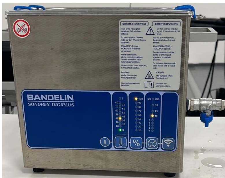
Obr. č. 4 - Fotografie ultrazvukové čističky použité pro čištění broků – zdroj archiv autora
