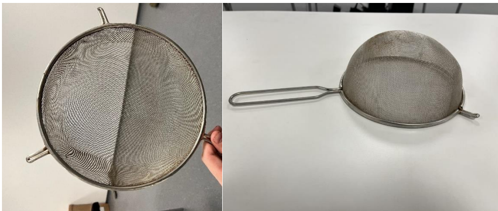
Obr. č. 3 - Fotografie síta používaného pro kontrolní prosévání menších částic laborátů – zdroj archiv autora
