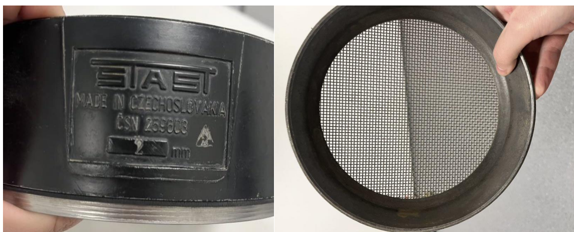
Obr. č. 2 - Fotografie kruhového síta používaného při první fázi prosévání – zdroj archiv autora
