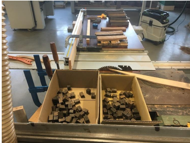
Obr. 15 Příprava vzorků na formátovací pile
