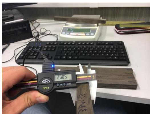
Obr. 13 Měření vzorku pomocí digitálního posuvného měřítka
