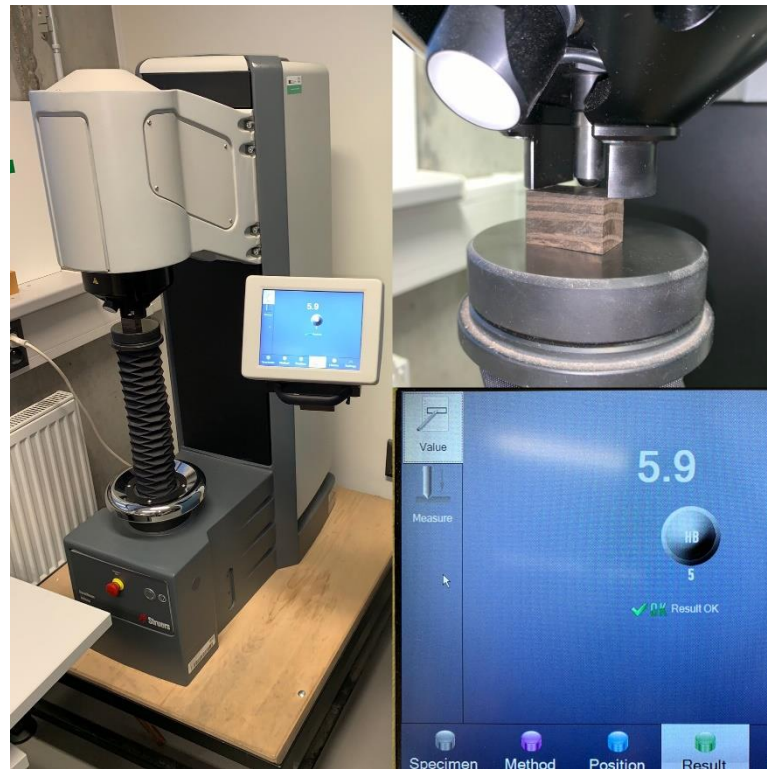
Obr. 17 Testování tvrdosti pomocí přístroje Duravision
