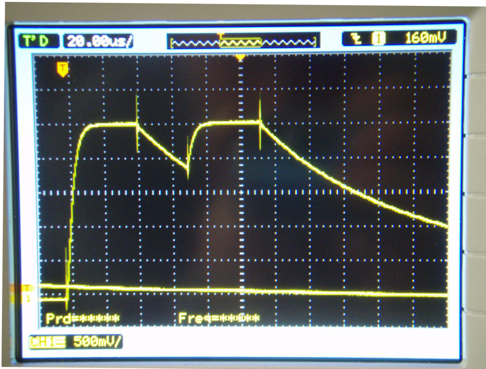
Obr.7.6 Reálný průběh vybíjení solárního článku
