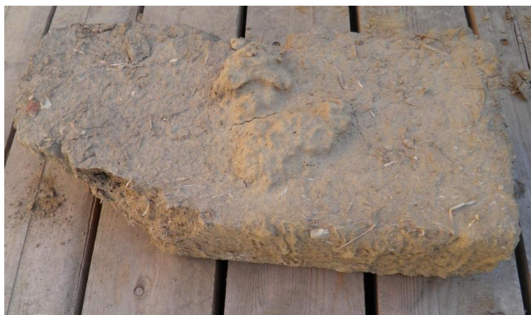
Obr. 4.8 Detail uvolněné nepálené cihly (vepřovice)
