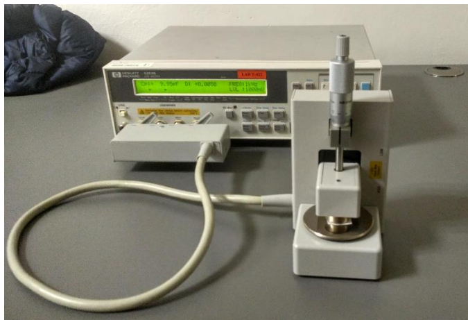
Obr. 17: Přístroje pro měření permitivity a ztrátového činitele
