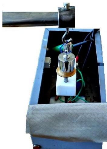
Obr. 16: Držák se závažím ve stínícím boxu
