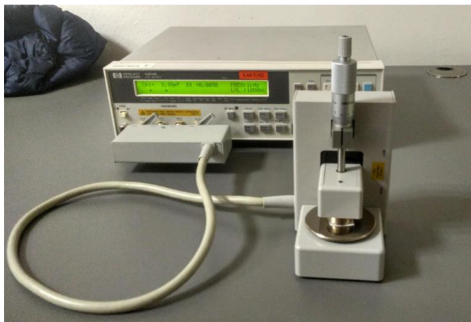
Obr. 17: Přístroje pro měření permitivity a ztrátového činitele
