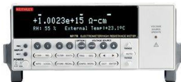
Obr. 12: Elektroměr KEITHLEY 6517B [36]
