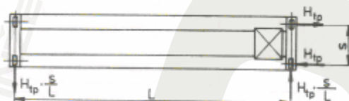
Obr. 9 Dvojice příčících sil vzniklé pojezdem dvou kol po jedné kolejnici
