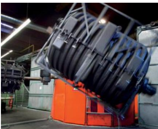
Obr. 13 – Výroba akumulčních nádrží Nautilus [27]
