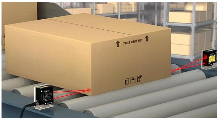
Obr. 31) Laserový senzor pro měření rozměrů krabice na dopravníkovém páse [44]
