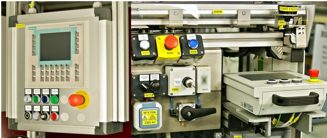
Obr. 2) Použití tlačítek na ovládacím panelu jednoúčelového stroje [10]
