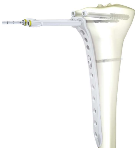
Obrázek 24: Operační proces – předvrtání otvorů [20].
