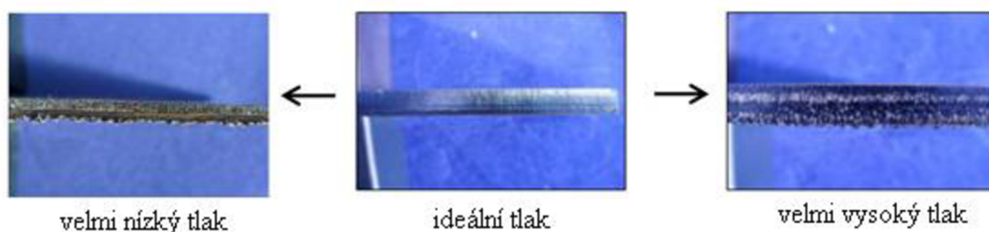
Obr. 30 Ukázka řezů s proměnlivým nastavením tlaku plynu [44].
