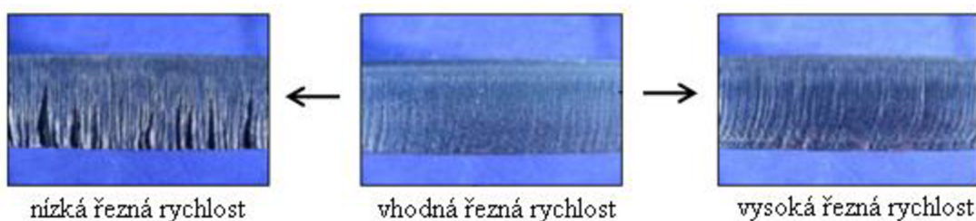
Obr. 25 Ukázka řezů s proměnlivou řeznou rychlostí [44].
