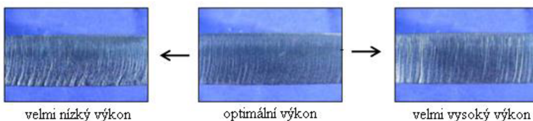
Obr. 24 Ukázka řezů s proměnlivým výkonem laserového paprsku [44].
