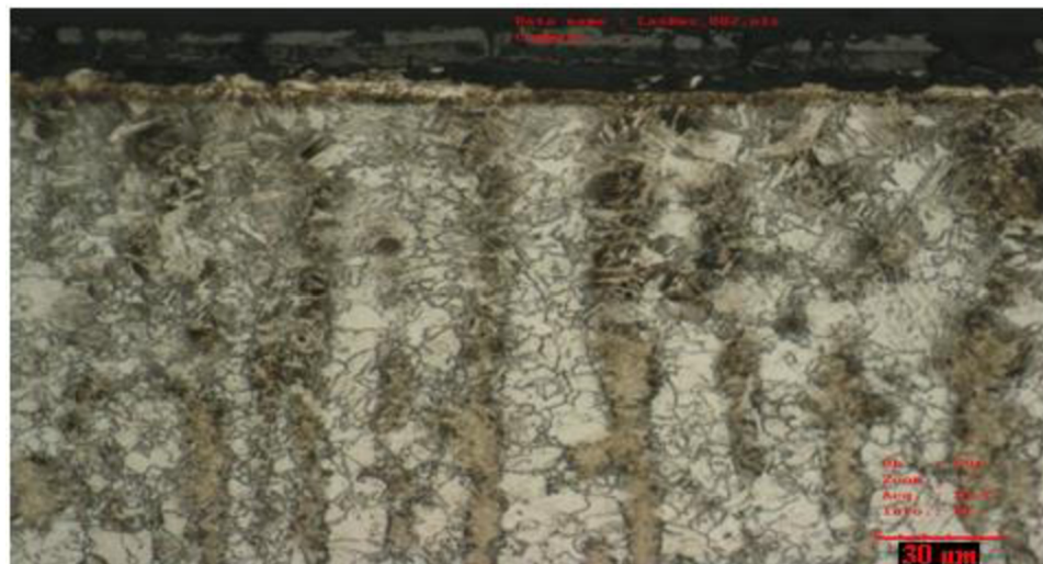
Obr. 69 Struktura tepelně ovlivněné oblasti oceli SSAB Laser 355 MC [23].
