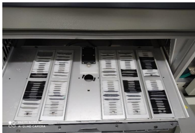
Obr. 18: Vzorky vystavené urychlenému stárnutí v klimatické komoře Q-SUN
