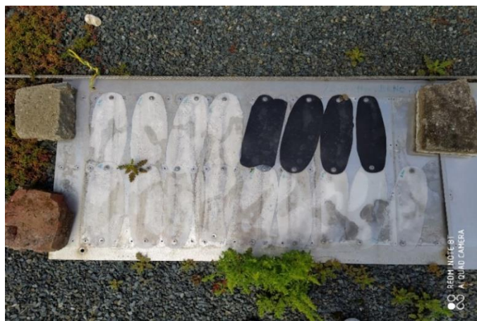
Obr. 17: Vzorky vystavené přirozenému stárnutí po 1 měsíci
