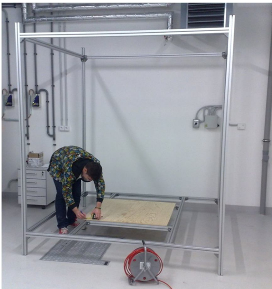
Obr. 12 - Nosná konštrukcia kalibračného boxu
