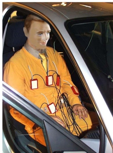
Obr. 9 Umiestnenie plošných zahrievaných čidiel na figurínu
