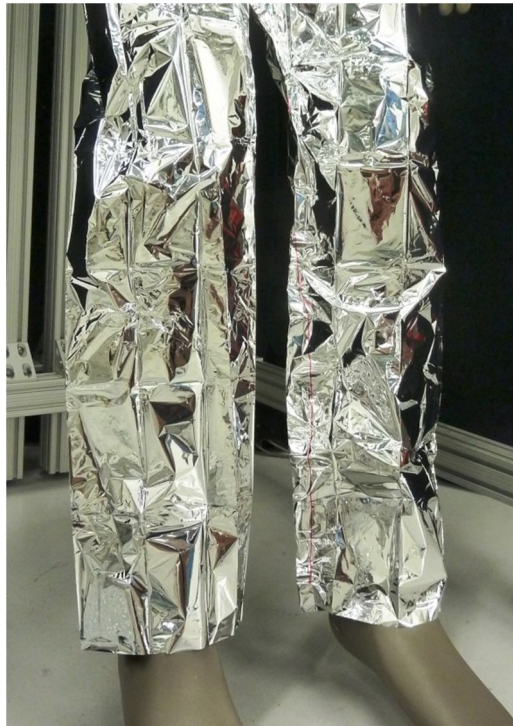
Obr. 20 Detail obleku s nízkou emisivitou
