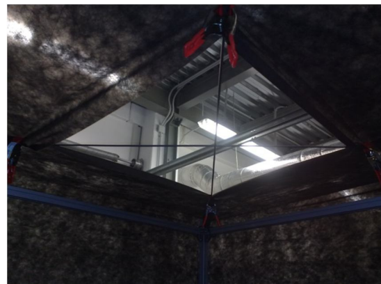
Obr. 13 - Vetrací otvor v stropnej časti boxu a pohľad na lanový záves pre manekýna
