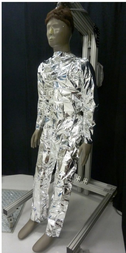
Obr. 17 Tepelný manekýn Newton s oblekom so zníženou emisivitou
