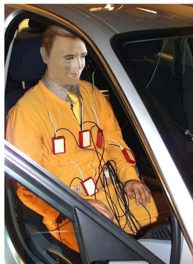
Obr. 9 Umiestnenie plošných zahrievaných čidiel na figurínu
