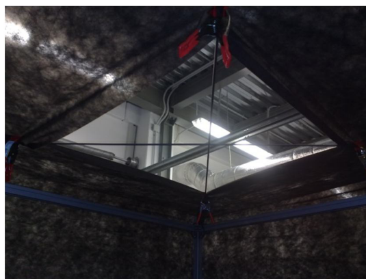
Obr. 13 - Vetrací otvor v stropnej časti boxu a pohľad na lanový záves pre manekýna
