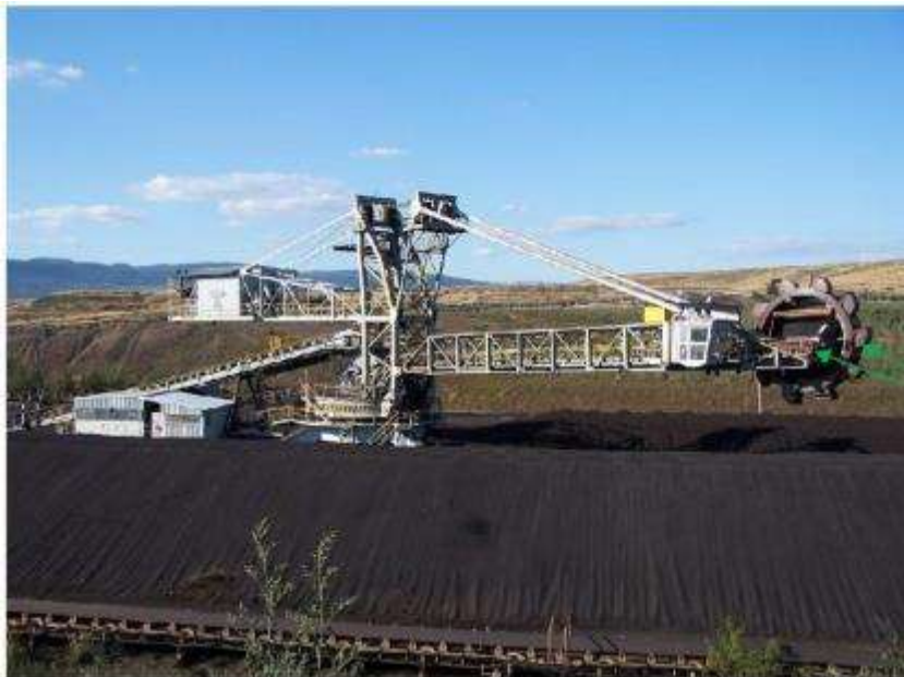
Obrázek 42: Umístění snímačů měřících výšku hromady na konci výložníku skládkového stroje (zakladače) [1]
