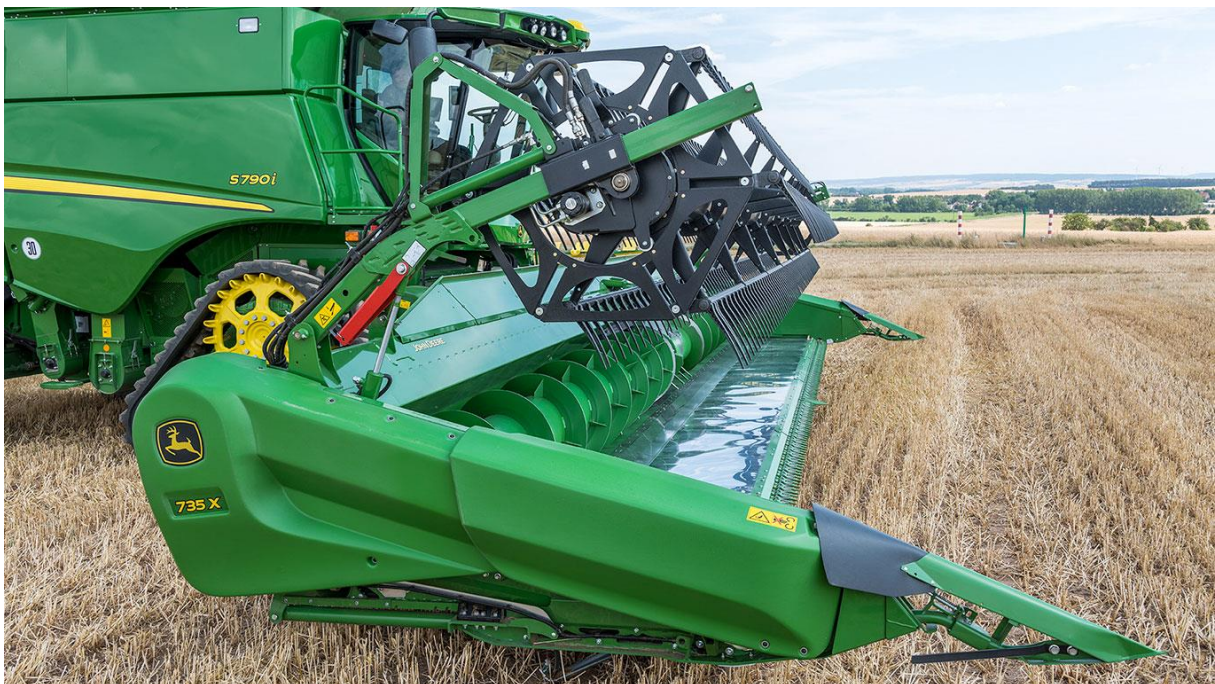
Obrázek 9 Žací lišta s pasivním plněním a variabilním výsuvem stolu řady X od firmy John Deere
