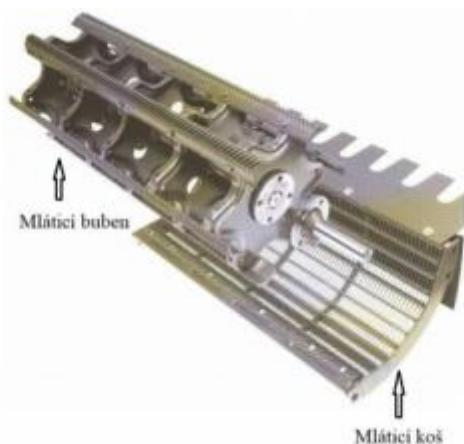
Obrázek 14 Mláticí buben o šesti mlatkách s mláticím košem
