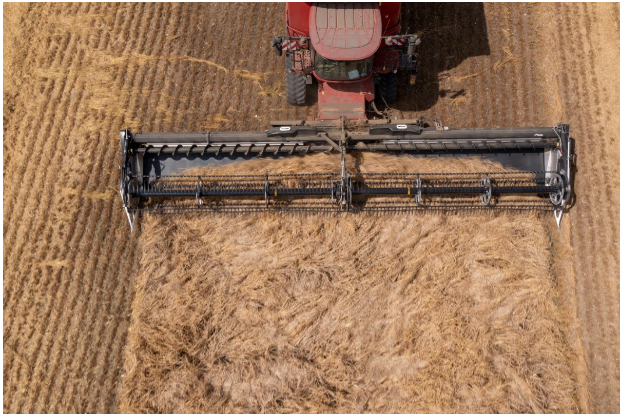
Obrázek 10 Pásová lišta s flexibilní kosou značky MacDon typ FD 235 při kosení polehlého porostu ve flexibilním režimu.
