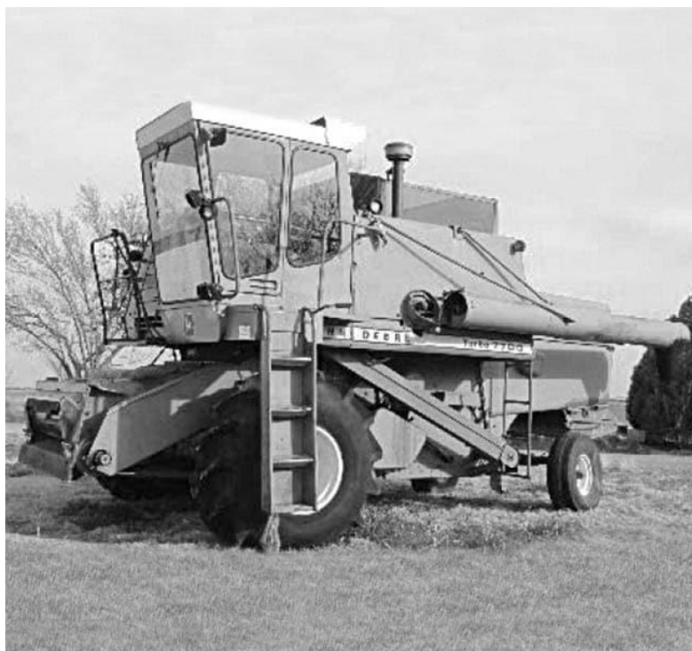
Obrázek 4 Sklízecí mlátička John Deere 7700 s možností výměny sklízňového adaptéru
