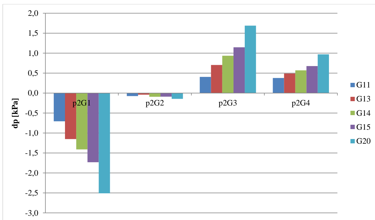
Graf 4 Rozdíl tlaků před a po uzavření rozvaděče na dolních snímačích
