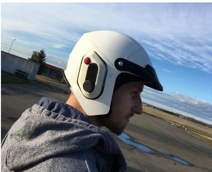
obr. 6-10 3D tisk přilby s interkomem
