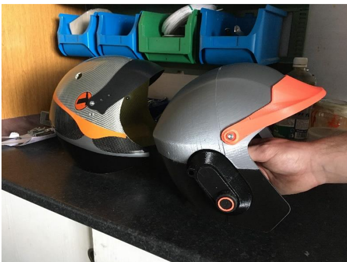
obr. 6-10 3D tisk přilby s interkomem
