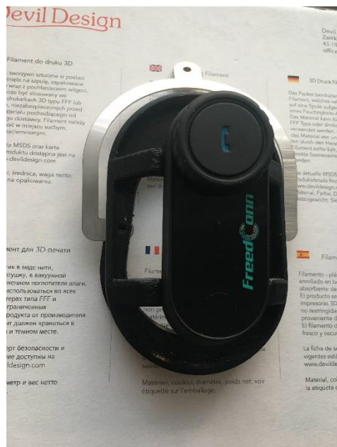
Obr. 6-19 Vnitřní osazení sluchátka
