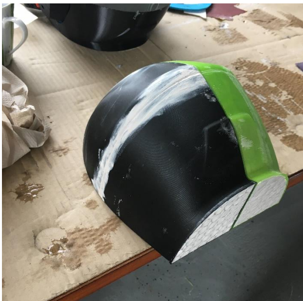
Obr. 6-13 Výroba kopyta – vylito sádrou
