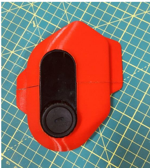
obr. 6-9 3D tisk sluchátka osazen interkomem
