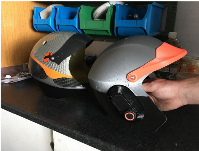
obr. 6-10 3D tisk přilby s interkmem
