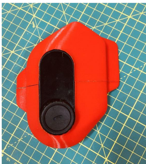
obr. 6-9 3D tisk sluchátka osazen interkomem
