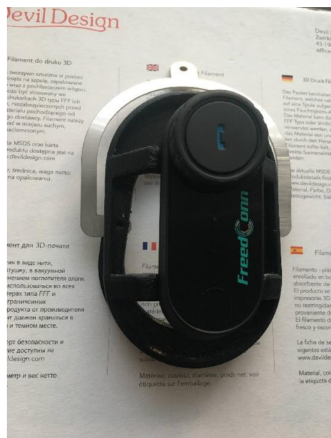
Obř. 6-19 Vnitřní osazení sluchátka
