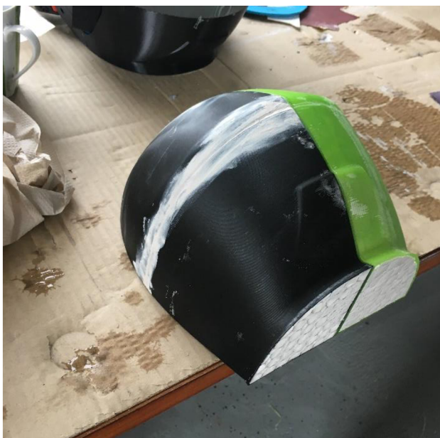
Obr. 6-13 Výroba kopyta – vylito sádrou
