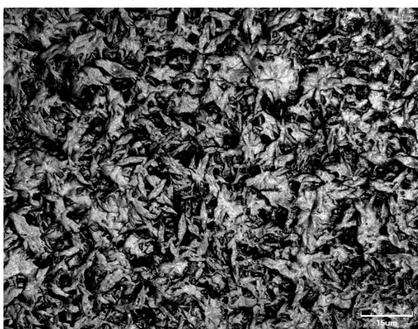
Obr. 47 CLSM snímek PA12 po tlakovém charakterizačním měření
