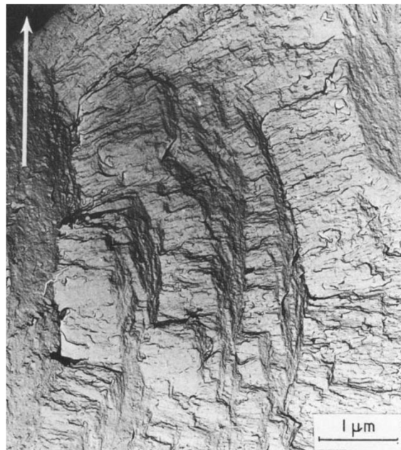
Obr. 12 SEM snímek repliky lomové plochy PA6 vzniklého izotermickou krystalizací z taveniny za při 295 °C po dobu 48 h a tlaku 6,5 kbar [23]
