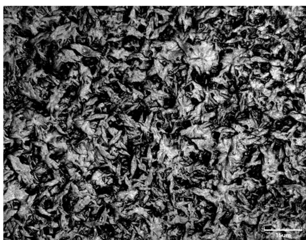
Obr. 47 CLSM snímek PA12 po tlakovém charakterizačním měření
