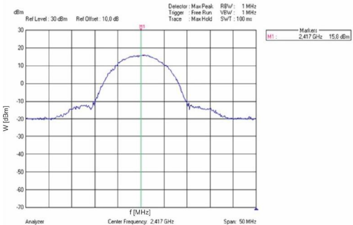
Obr. 2.11: Měření špičkové spektrální hustoty výkonu TX zařízení WL-1120 AP.
