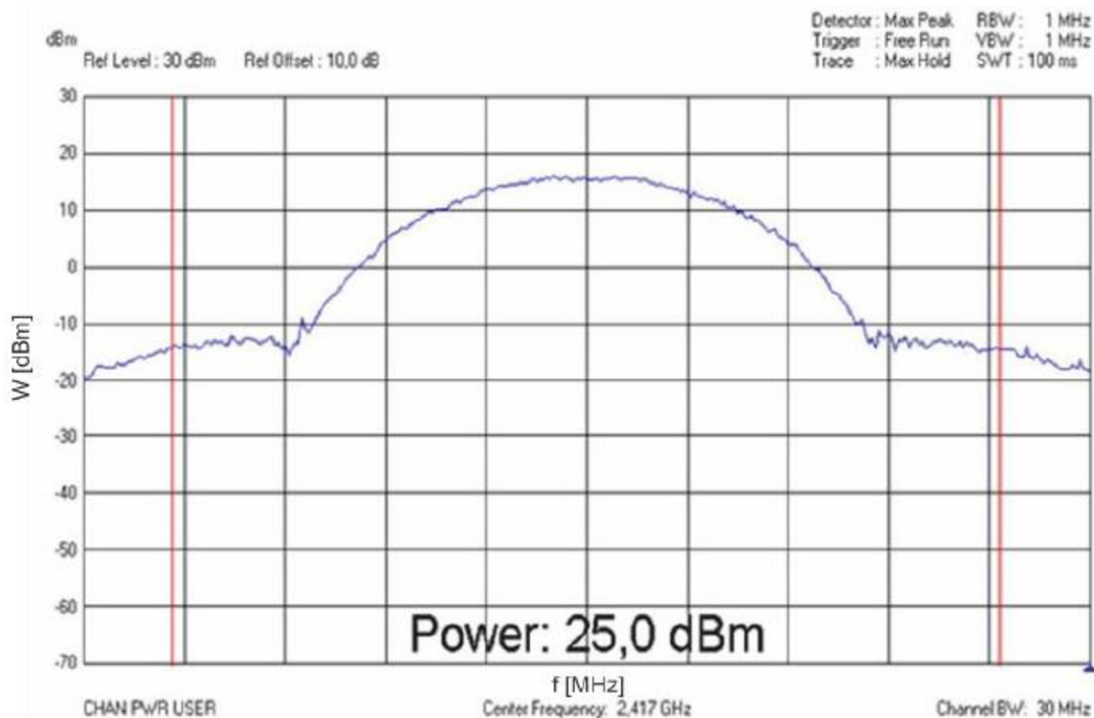
Obr. 2.12: Měření celkového spektrálního výkonu TX zařízení WL-1120 AP.
