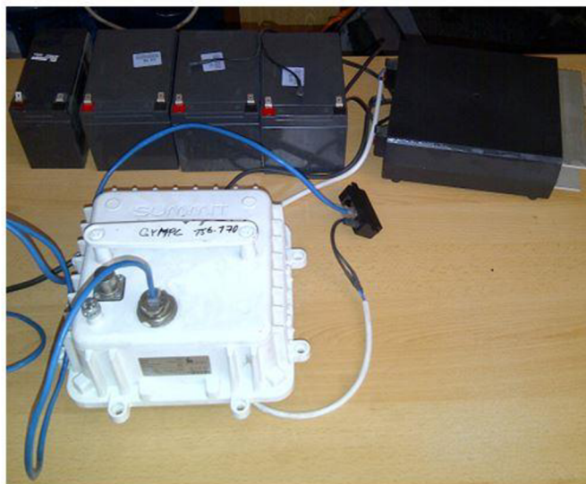
Obr. 3.10: Ukázka vlastní realizace navrženého záložního zdroje – 48V s AD-155.
