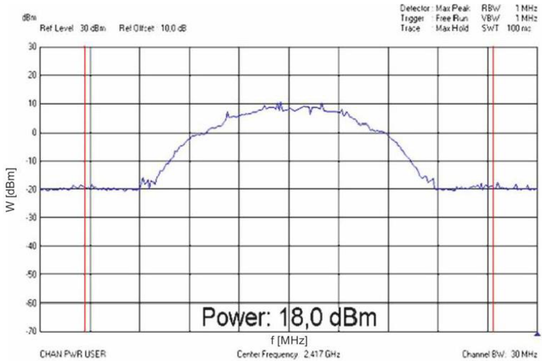
Obr. 2.10: Měření celkového spektrálního výkonu TX zařízení Planet WA-1911.
