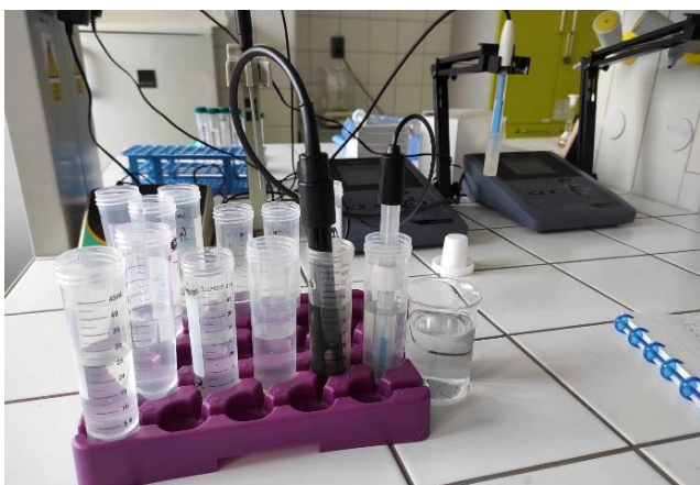
Obrázek 17: Měření konduktivity a pH
