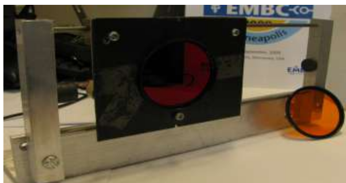
Obr. č.15: Realizovaný translační systém umožňující vložení emisního filtru do optické cesty snímání
