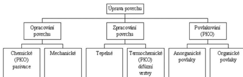
Obr. 3 Rozdělení úprav povrchu (PKO - protikorozní ochrana) [5]
