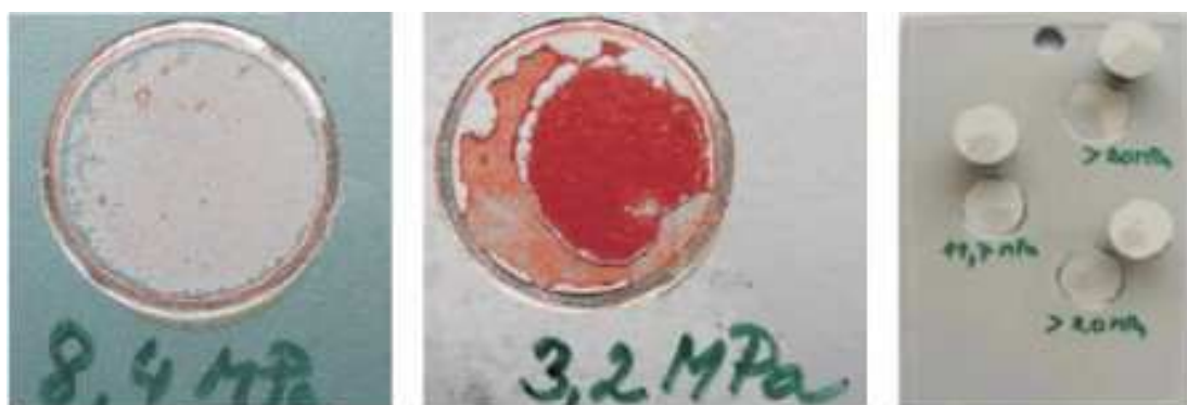
Obr. 6 Názorný vliv typu porušení (vlevo adhezivní porušení, uprostřed smíšený lom adhezivně-kohezivní) na hodnotu pevnosti v odtrhu [5]
