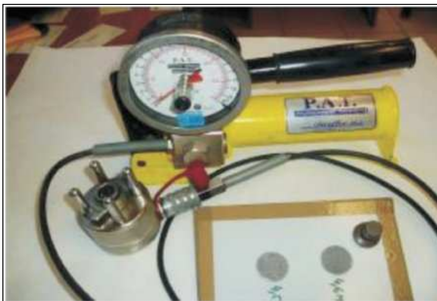
Obr. 5 Příklad hydraulického přístroje na měření přilnavosti odtrhem [5]
