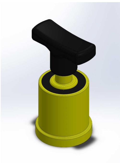
Obr. 7 Konceptní návrh přípravku na ořezávání zkušebních odtrhových tělísek pro eliminaci ohybového momentu [vlastní zdroj]
