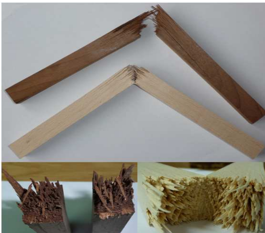
Obr. 41 Lom způsobený rázovou zkouškou u přírodního buku a tepelně ošetřeného buku (190 °C, 1 h).
