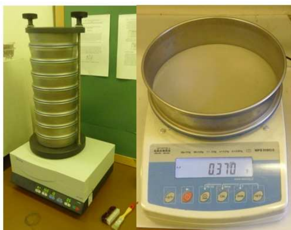
Obr. 38 Vibrační síťovací stroj se sadou sít a laboratorní váha
