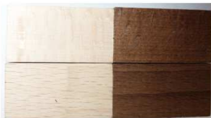
Obr. 4 Barevná změna buku upraveného při teplotě 191°C/1 h
