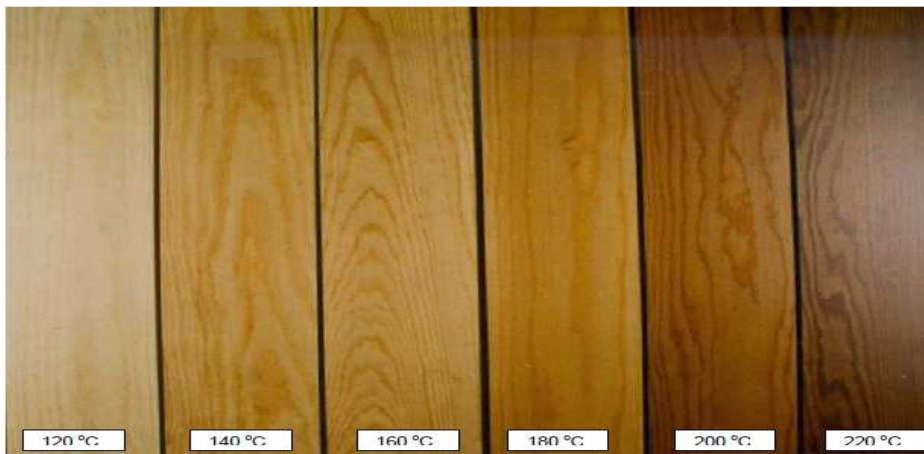
Obr. 87 Barevné změny borového dřeva upravené při 120 až 220 °C v intervalech po 20 °C. (Reinprecht 2008)
