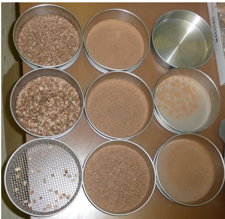
Obr 90. Sada sít (5; 2; 1; 0,5; 0,25; 0,125; 0,080; 0,032 a dno) s roztríděným vzorkem třísky tepelně ošetřeného buku.
