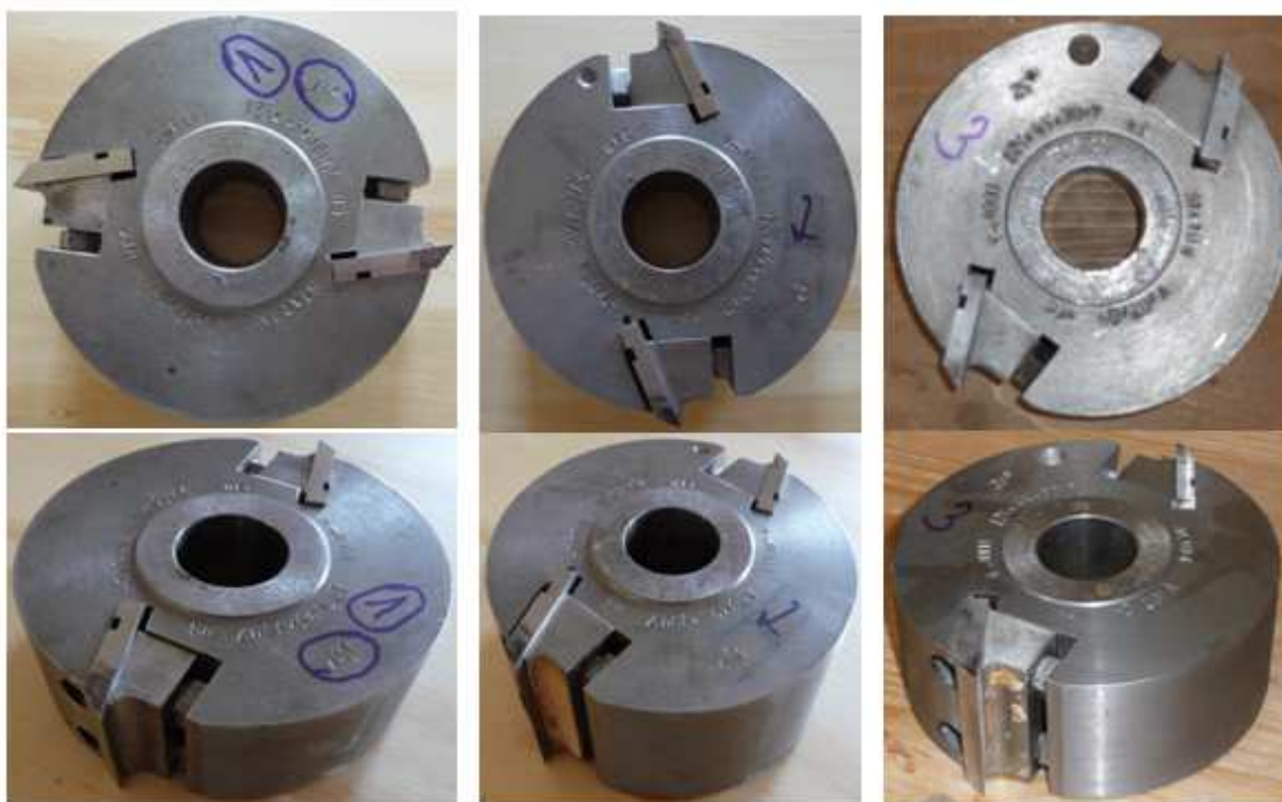
Fréza s úhlem čela 15°
