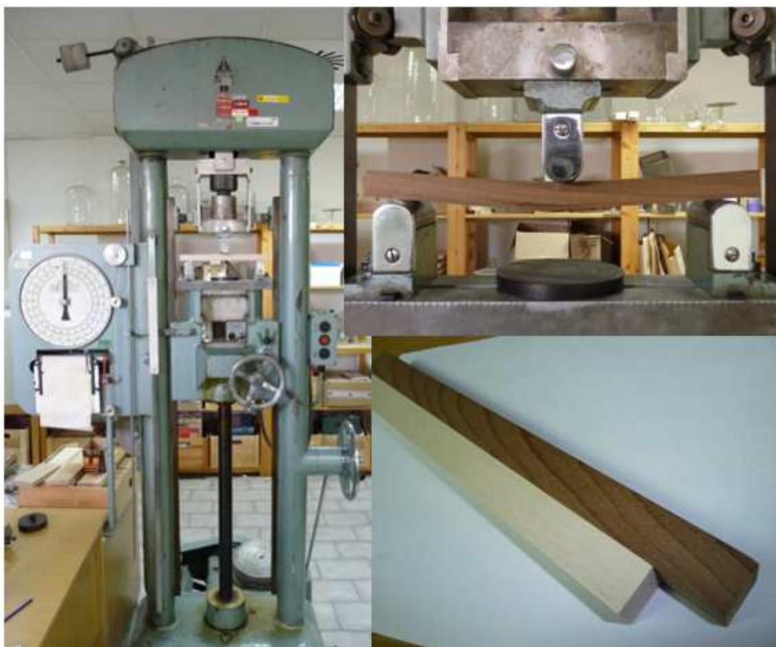
Obr. 39 Univerzální zkušební stroj ZDM 5/91 a zkušební tělíška.
