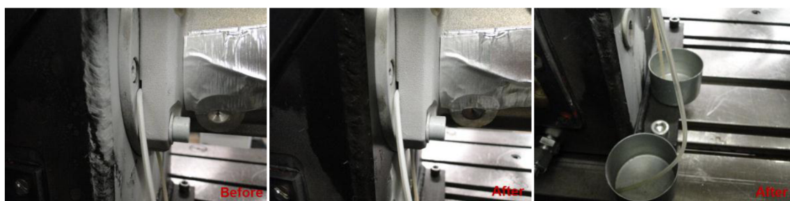
Obr. 9-9 Čerpadlo namontované na zkušební stanici dlouhodobé zkušebny
