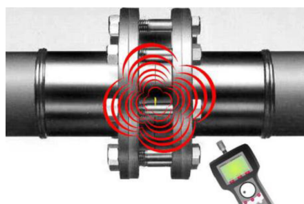
Obr. 5-1 Měření akustickou metodou [6]
