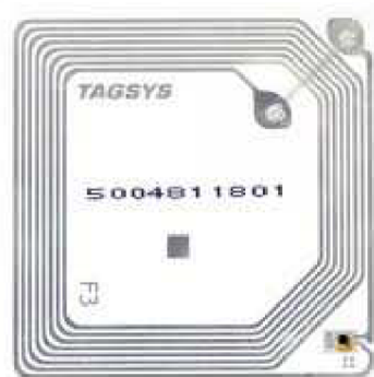
Obrázek 10 Příklad tag RFID systému. Zdroj: [12.]
