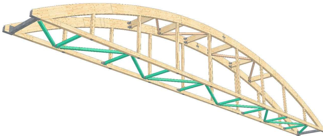
Obrázek 36: Spodní zavětrování mezi podélnými nosníky v úrovni mostovky (SEMA-autor DP, 2020)
