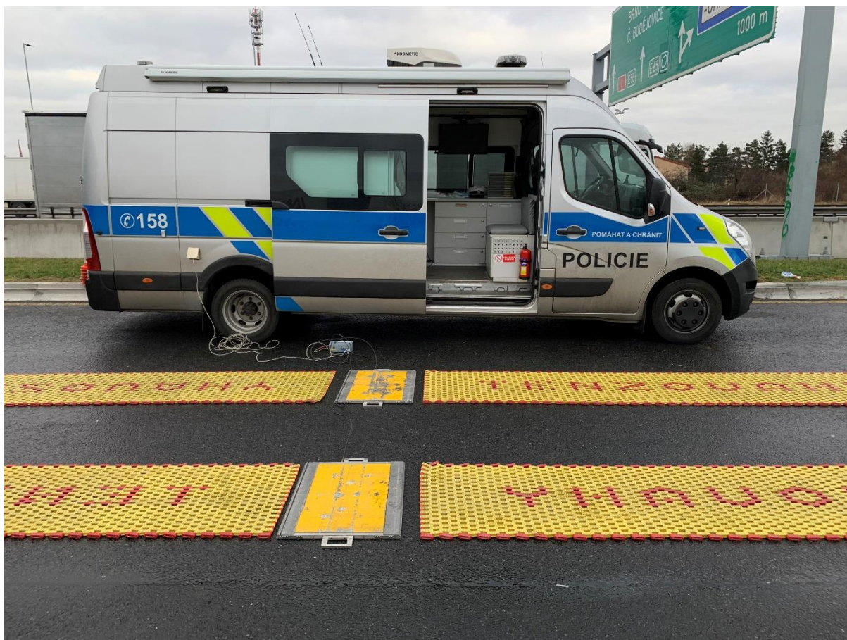
Obrázek č. 25 Kontrolní stanoviště (Renault Master pro speciální silniční dohled, Tenzováhy) 24
