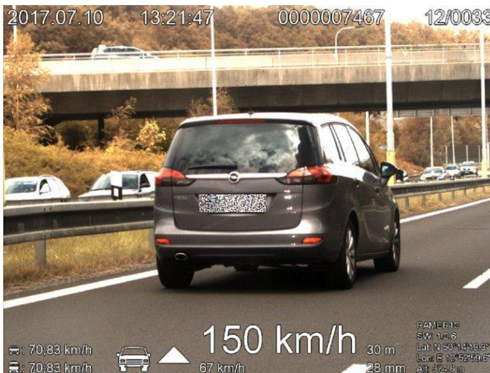
Obrázek č. 10 Příklad dokumentace přestupku zachyceným měřičem rychlosti RAMER 10 C 10
