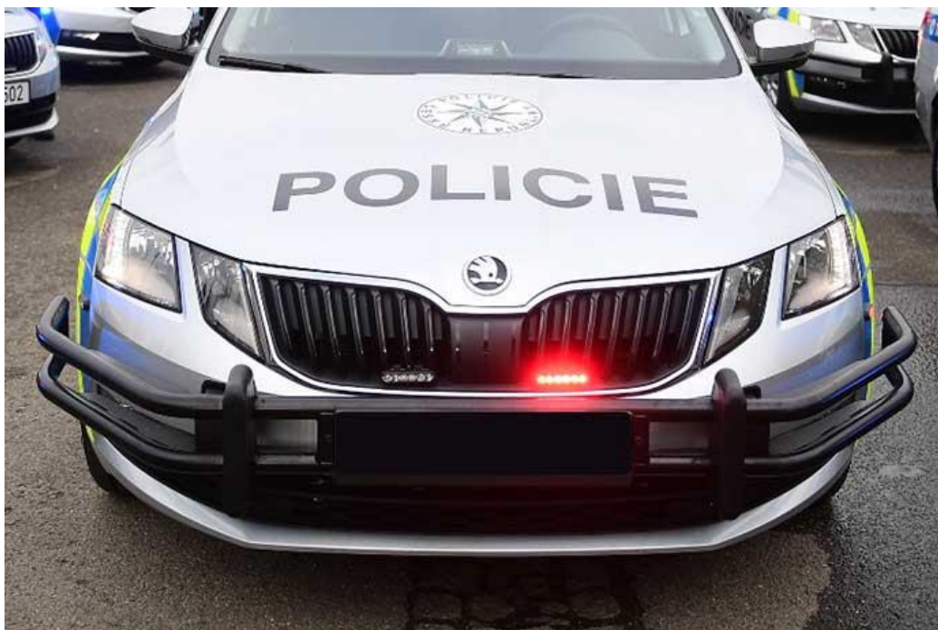
Obrázek č. 31 Služební vozidlo Škoda Octavia III opatřena bezpečnostním rámem 30
