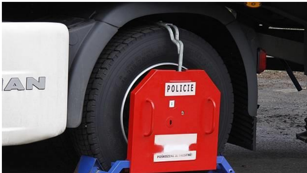
Obrázek č. 26 TPZOV použita na nákladní vozidlo 25
