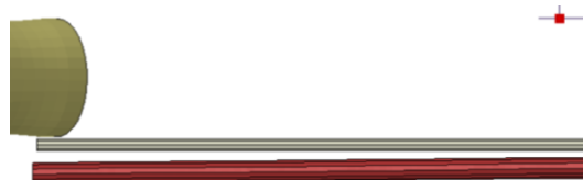
Obrázek 36: Průhyb konce tyče po opuštění rovnačky
