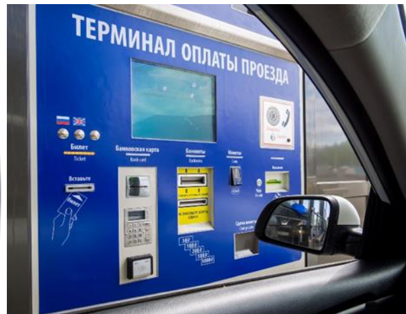
Obr. 3 – Platební terminál na mýtné bráně
