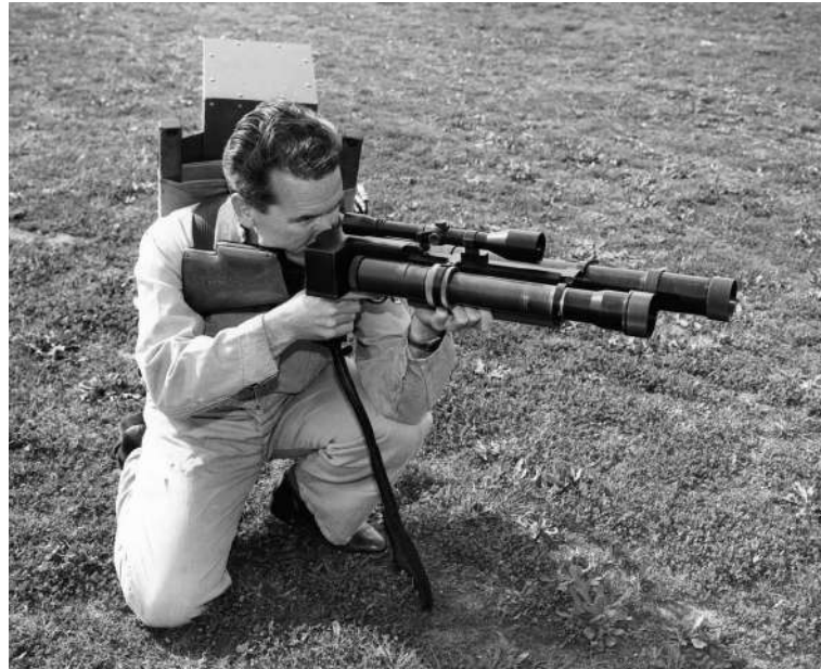
Obr. 2.1: Ing. Rod Smith mieri CoLiDAR Mark II, ktorý bol prvý komerčne vyrábaný LiDAR na svete. Prevzaté z [60]
