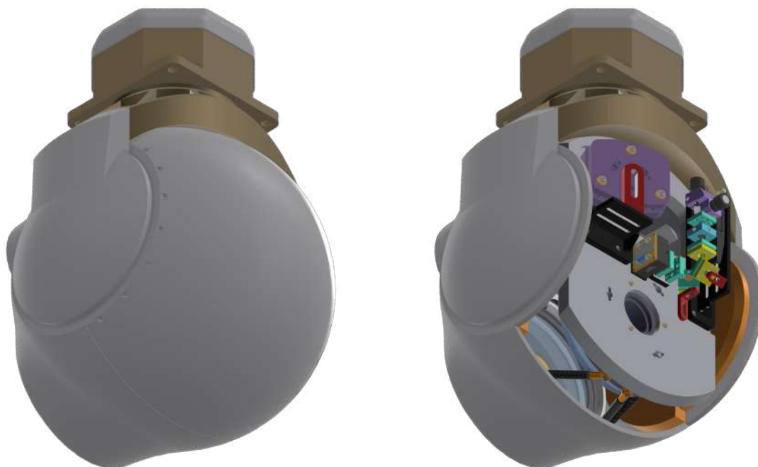
Obr. 7.8: Pohľad na zadné krytovanie koncepčného návrh pre letecké účely.
