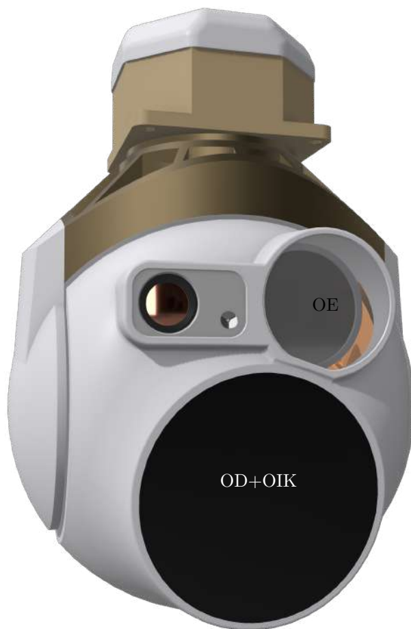
Obr. 7.7: Konceptný návrh pre letecké účely, kde OE je optika emitora a OD+OIK je spoločná optika detektora a infračervenej kamery.
