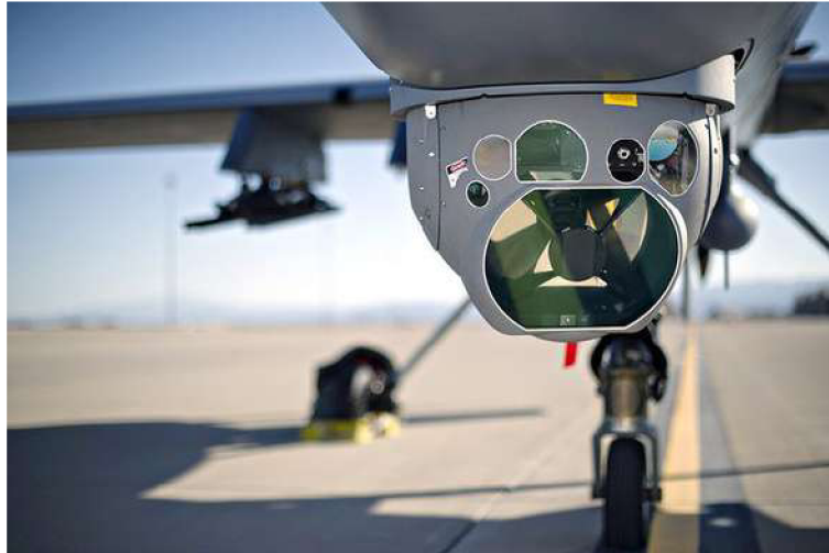
Obr. 3.2: Príklad uloženia funkčných častí optického systému na jednom konštrukčnom ráme bezpilotného drona. Prevzaté z [74].
