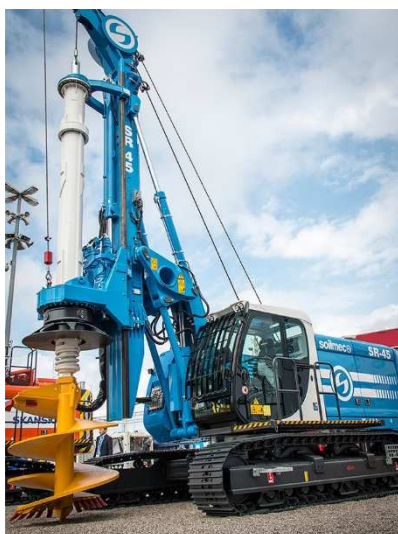
Obrázek 8.5 – Vrtná souprava na pásovém podvozku Soilmec SR-45 [21]
