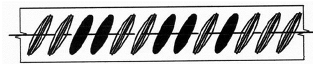
Obrázek 10.1 – Značení žebříkové oceli s třemi řadami žebírek s třídou duktility B500B [58]
