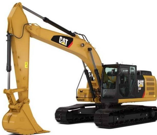
Obrázek 8.1 – Rypadlo na pásovém podvozku CAT 326F [17]
