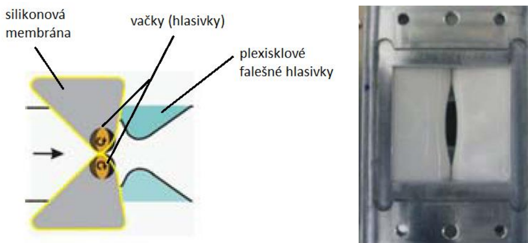
Obr. 10.27 Dynamický model hrtanu [18]: schéma modelu (vlevo), reálný model mezihlasivkové mezery (vpravo)
