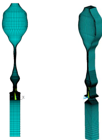
Obr. 12.4 Modely akustických prostorů průdušnice a vokálního traktu pro rovinnou (vlevo) a prostorovou úlohu (vpravo)
