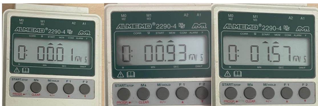
Obr 5. Naměřené hodnoty rychlosti proudění vzduchu
