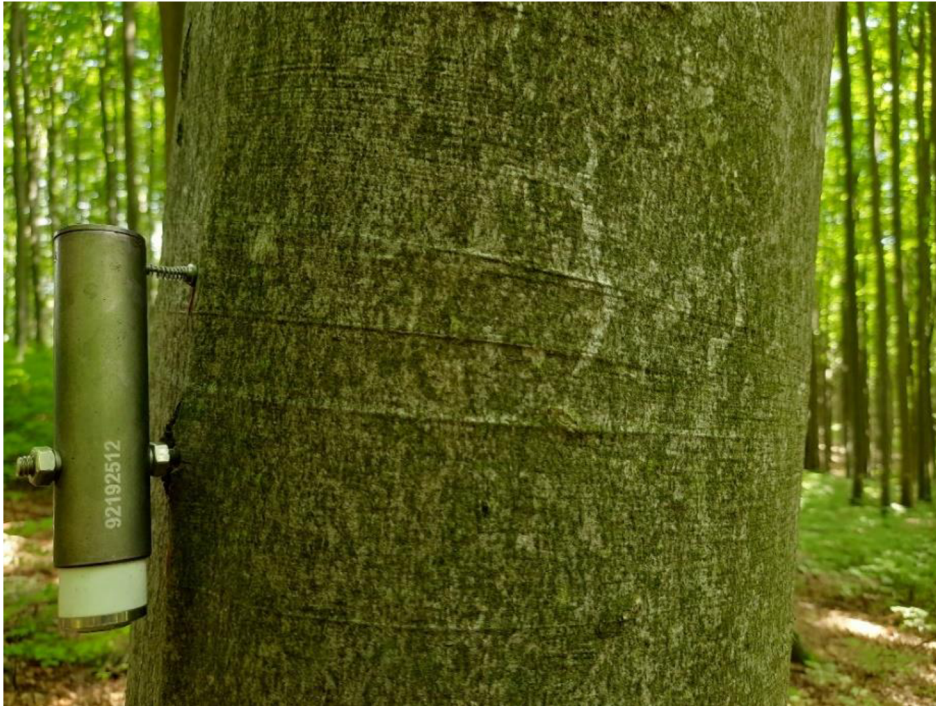
Obrázek 5 – Dendrometr TOMST s evidenčním číslem 92192512 zaznamenávající průběh tloušťkového růstu buku lesního (zdroj: autor práce)
