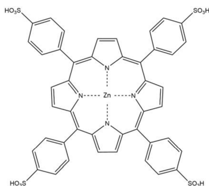
Obr 14.: Strukturní vzorec zine-5,10,15,20-tetrakis(4-sulfonatofenyl) porfyrin (ZnTPPS 4 ).
