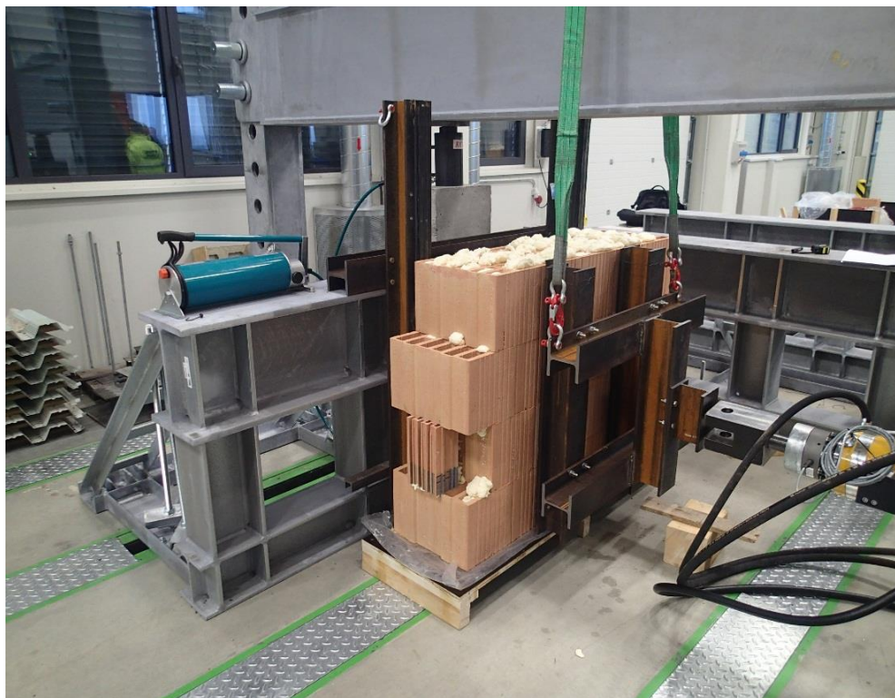
Obrázek č. 26 – Umístění tělesa do zkušebního přístroje
