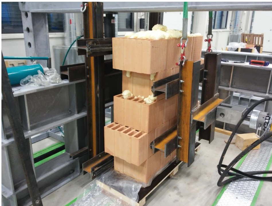
Obrázek č. 29 – Zkoušený fragment zdiva umístěný ve zkušební přístroji
