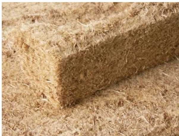
Obrázek č. 23 – Izolace z technického konopí [13]
