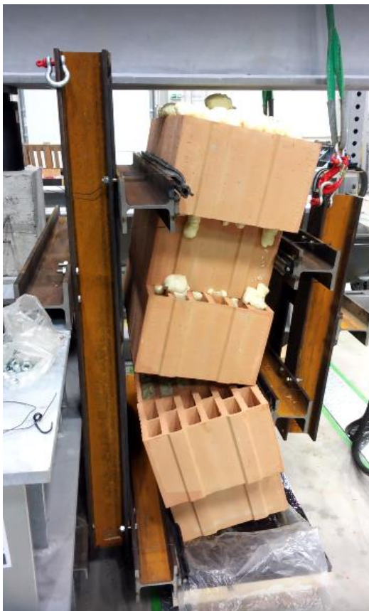
Obrázek č. 30 – Porušení zdiva
