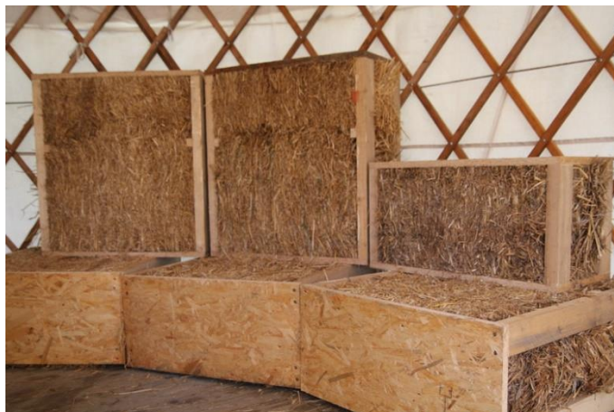
Obrázek č. 22 – Panely ze slaměné izolace [12]
