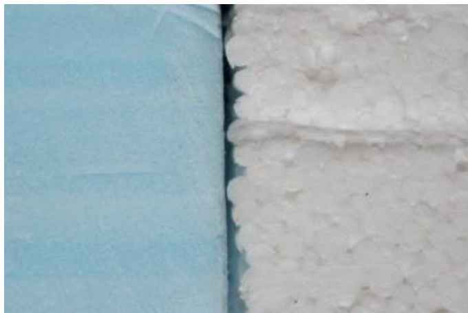
Obrázek č. 18 – Porovnání extrudovaného a pěnového polystyrenu [8]
