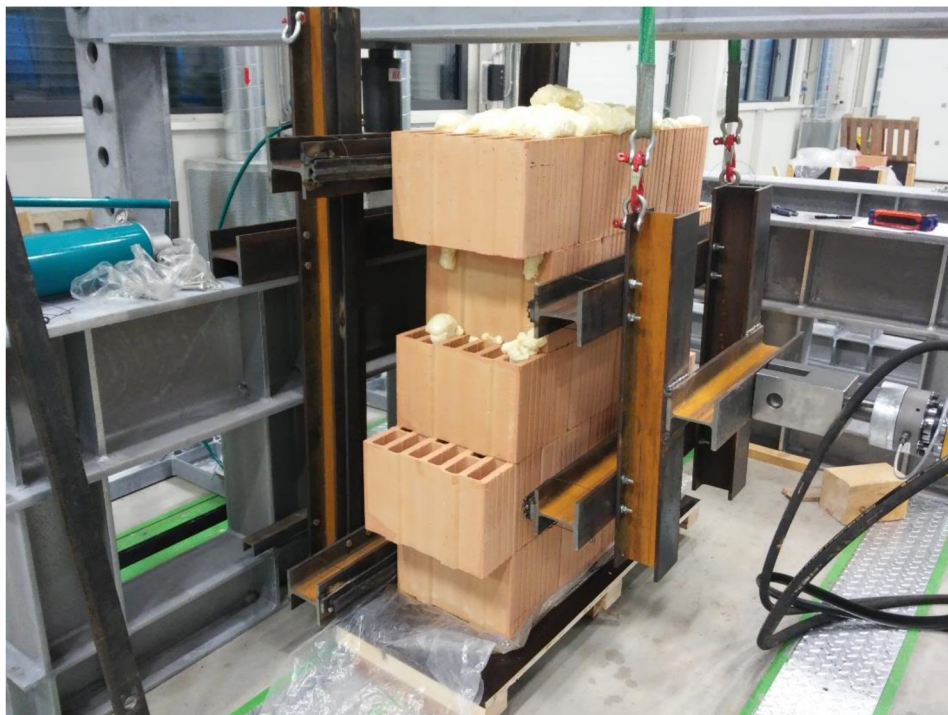
Obrázek č. 29 – Zkoušený fragment zdiva umístěný ve zkušebním přístroji
