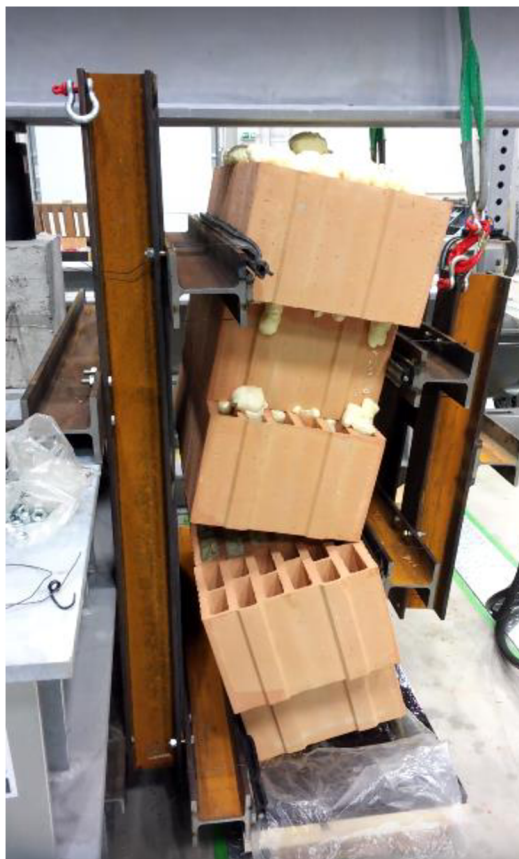
Obrázek č. 30 – Porušení zdiva
