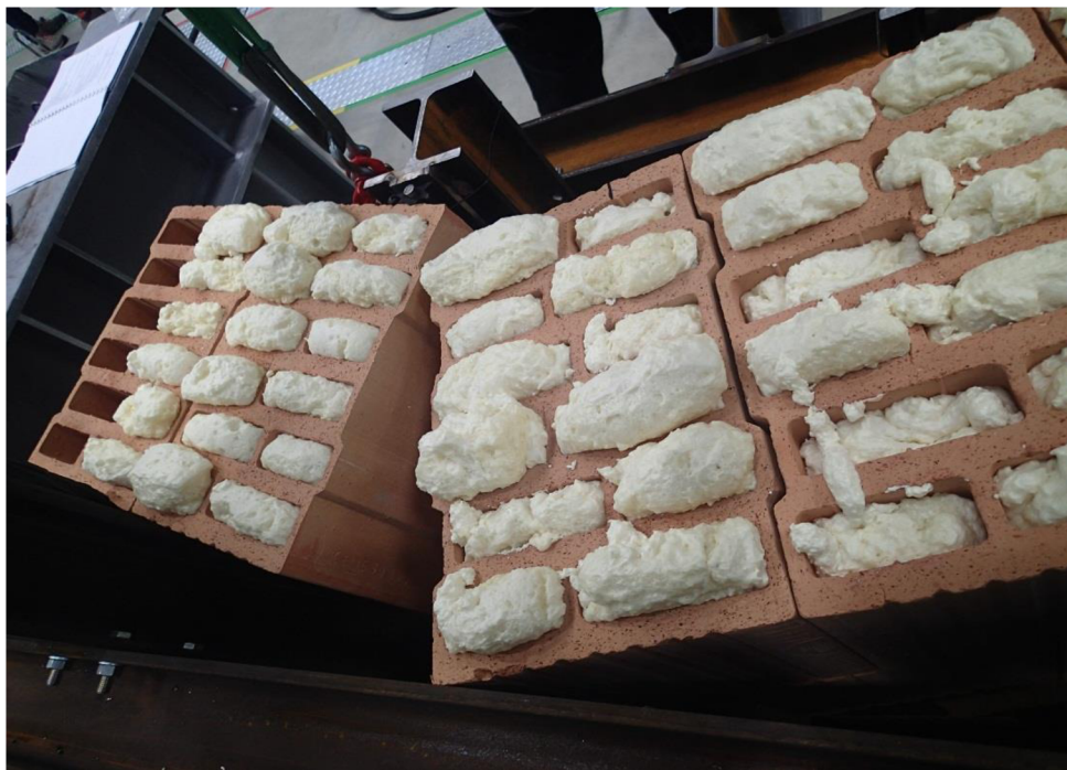
Obrázek č. 27 – Porušení zdiva při namáhání v tahu za ohybu
