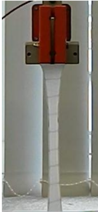
Obrázek 28.: Tahová zkouška mat. v příčném směru
