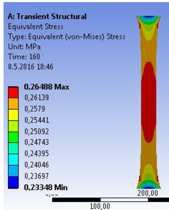
Obrázek 27.: Simulace tahové zkoušky
