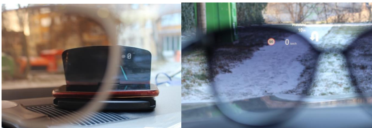
Obr. 28: Viditelnost za použití polarizačních (vlevo - HUD E) a slunečních brýlí (vpravo - HUD A)
