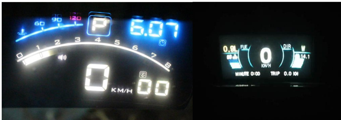
Obr. 27: Oslnění za tmy (vlevo – HUD C, vpravo - HUD D)
